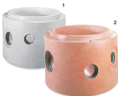
❶ Schachtkörper, Gerinne und Auftritt (Berme) aus Beton C 40/50; Wassereindringtiefe < 20 mm
